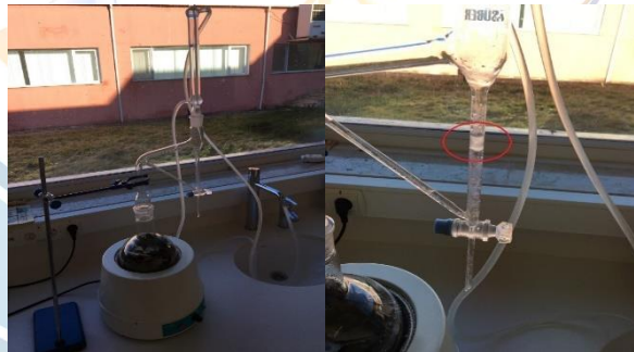
Görsel 1: Bitki yaprak ve meyvelerinden uçucu yağ elde etmek için laboratuvar çalışmaları
