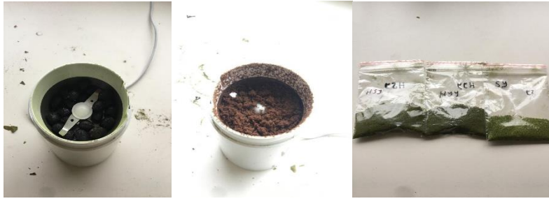
Görsel 2: ICP-MS çalışmaları için ön hazırlıklar (örneklerin kurutularak toz haline getirilmesi)
